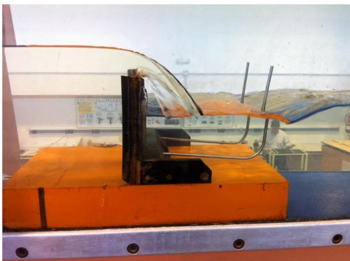
Figura 4. Imagen con información sobre resalto hidráulico subida a la App
