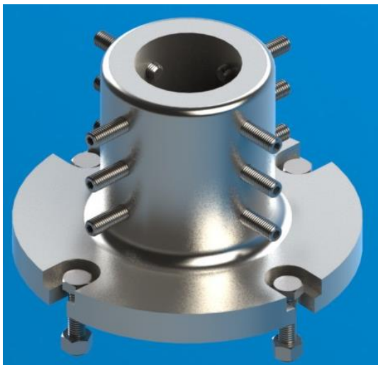
Figura 2: Diseño del dispositivo alternativo al plato de garras vertical sujetando una pieza
